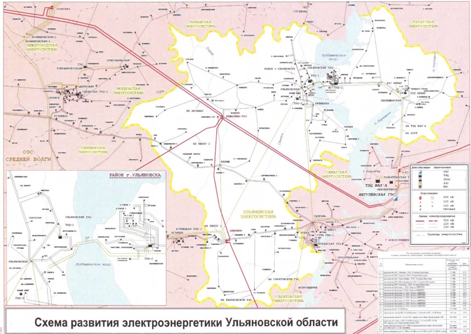
Рис. 2. Карта-схема электрических сетей классом напряжения 110 кВ и выше энергосистемы Ульяновской области на период 2019-2023 годов
